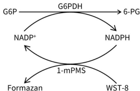
图1. 增强型NADP<sup>+</sup>/NADPH检测试剂盒(WST-8法) (S0180)的工作原理图。
