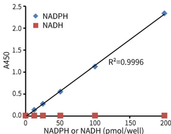
图2. 碧云天增强型NADP<sup>+</sup>/NADPH检测试剂盒(WST-8法) (S0180)检测NADPH的标准曲线。上图显示本试剂盒可以很好地检测出NADPH的含量，并且不会受NADH的干扰。不同的检测条件下，实际读数会因标准品的配制、检测仪器等的不同而存在差异，图中数据仅供参考。
